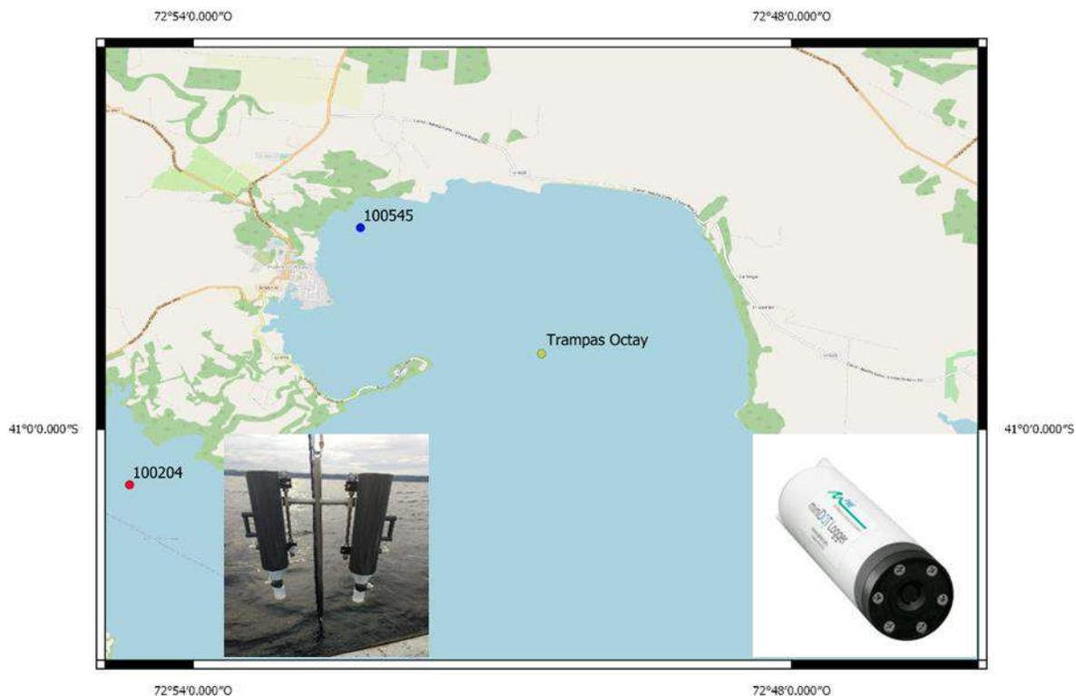
**Figura 96.** Localización e imagen de las trampas de sedimentos ancladas en bahía Puerto Octay junto con los sensores de temperatura y oxígeno puestos a las profundidades de las trampas (15 y 75 m de prof).
