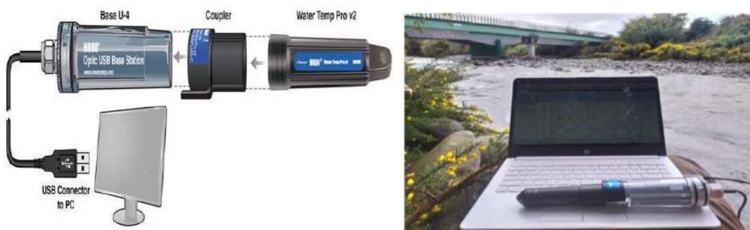
Figura 9: Esquema de descarga de sensores a un ordenador.
