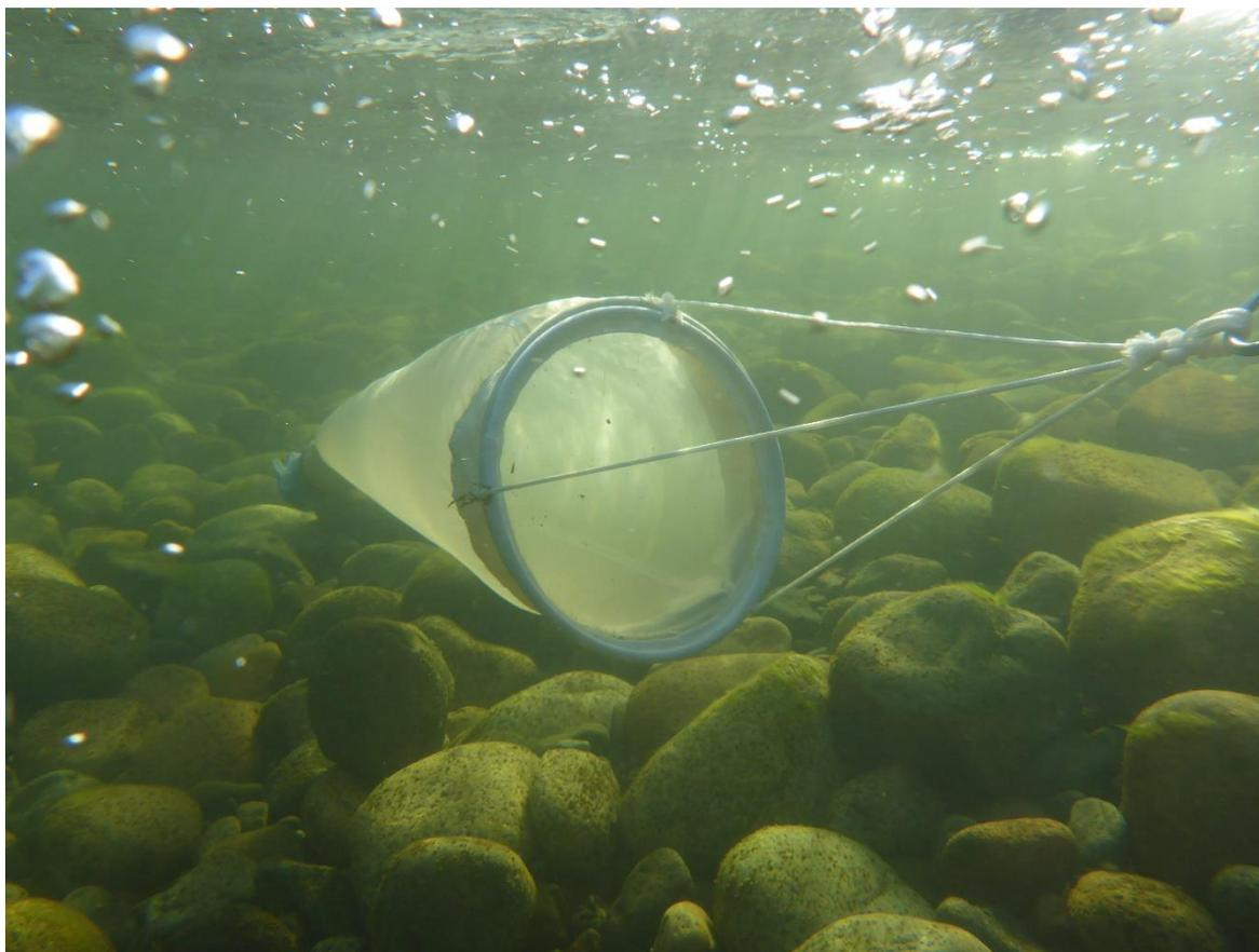
**Fotografía 2:** Red fitoplanctónica en suspensi3n filtrando agua para la obtenci3n de muestra.
