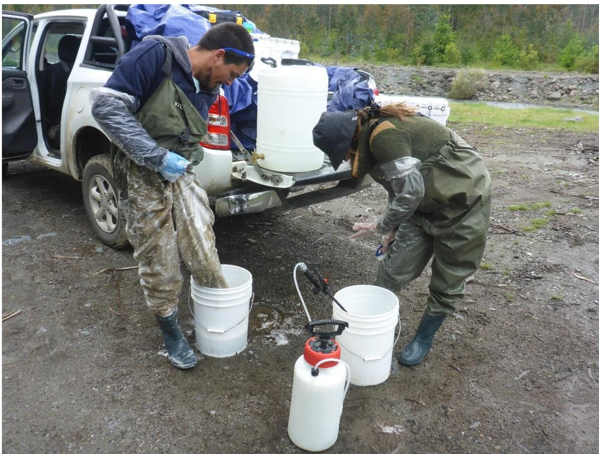
**Fotografía 3.** Aplicaci3n de protocolo de desinfecci3n de elementos de muestreo y waders.
